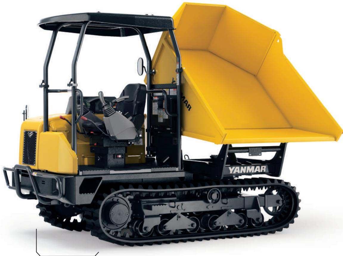
全幅 180°旋回ベッセル仕様 **1565mm** / 三方開きベッセル仕様 **1590mm**
