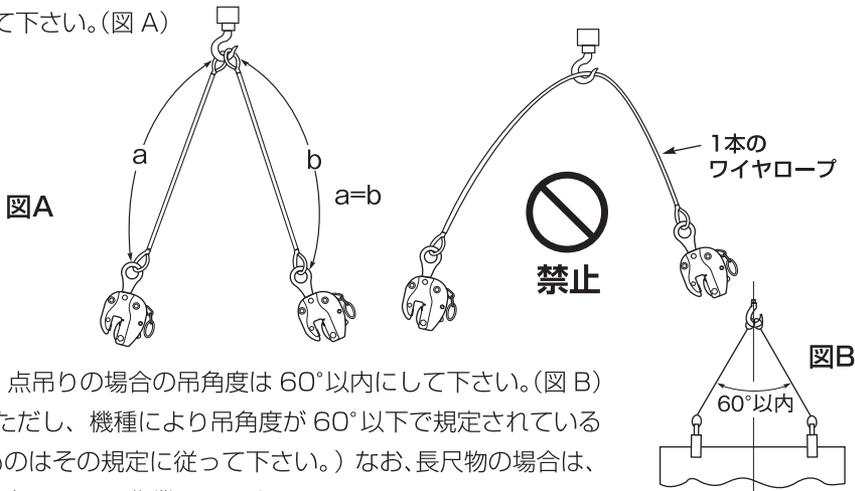
10. 2 点吊りの場合の吊角度は 60° 以内にして下さい。（図 B）
