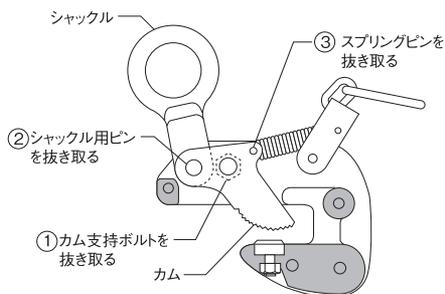
②シャックルおよびカムを本体より引き出し、シャックル用ピンを抜き、カムよりシャックルを取り外して下さい。
