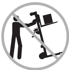
位置の微調整を行う以外、積載が上昇した状態で機械を移動しないでください。
